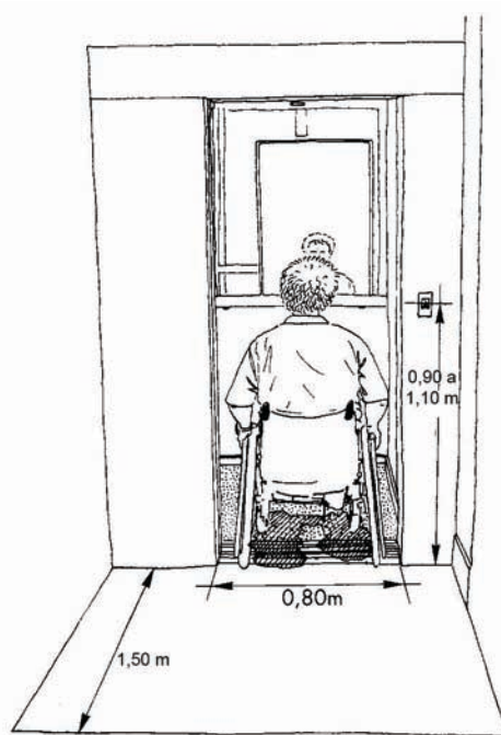
Rellano de embarque y cabina de ascensor.
